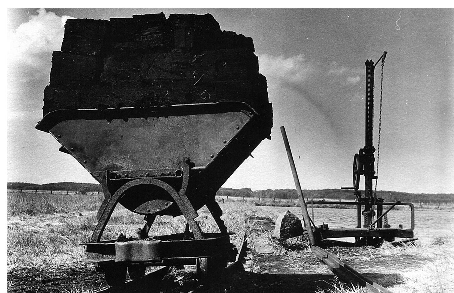
2023: Aktuelles Projekt – die große Torstechmaschine des Museums wird restauriert, Baujahr ca. 1900. Das Führen der Maschine ist schwerste Handarbeit. Vorn eine Torflöre bepackt mit Torfsoden.
